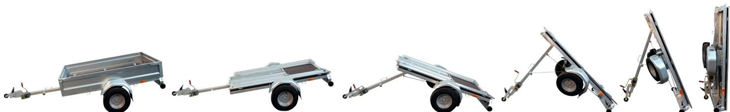
Assurez-vous que la remorque est pliée le long d'un mur et si possible reliée à celui-ci par une chaîne de sécurité ou un câble (non fourni avec la remorque)!
