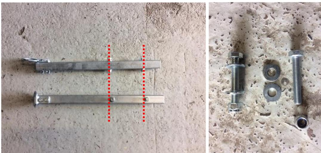
2) Le bras élargisseur se fixe sur l'avant gauche ou droit de la remorque, en dessous du catadioptre blanc, au niveau de la platine d'acier épaisse. Positionner l'un des bras
