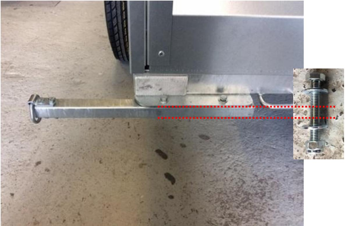
3) Resserrer la boulonnerie avec 2 clés de 11 et procéder de la même manière pour l'autre bras.
